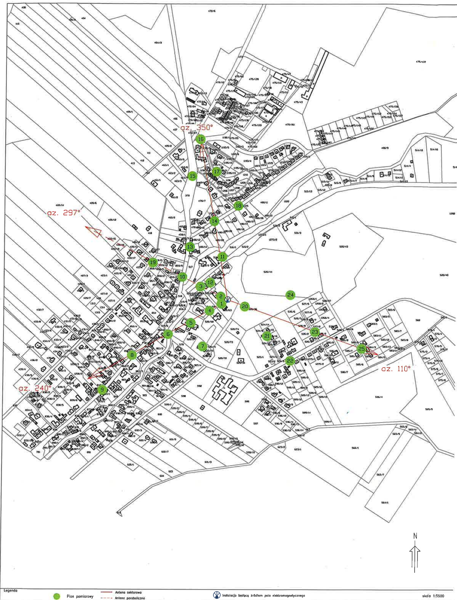
Rys.1 Lokalizacja pionów pomiarowych
